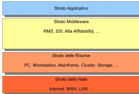
*Figura 1.4:* Schema ad alto livello d'astrazione di una griglia computazionale.
